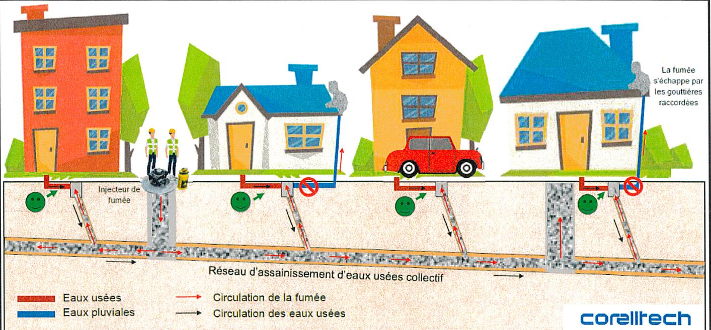
**La commune de Froideville fait l'objet d'un contrôle du réseau d'assainissement des eaux usées par tests à la fumée.**
